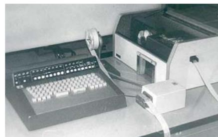
Die "ZUSE" im Betrieb: Abrechnungsdaten werden auf Lochstreifen übertragen
