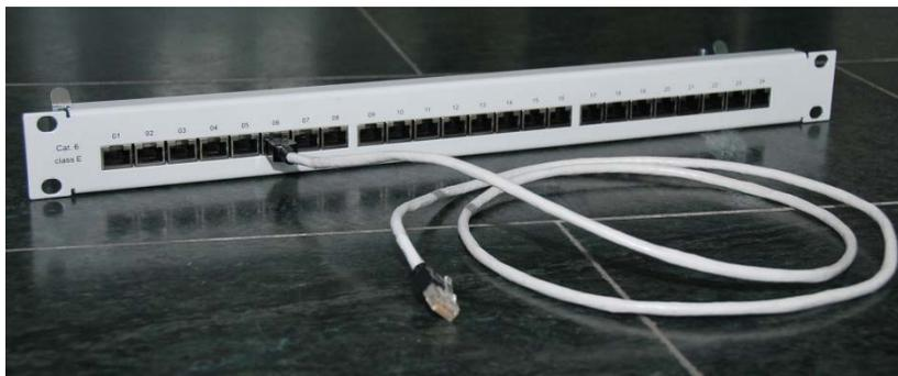
**Abbildung 3** Kategorie 6 Verteilerfeld und Verteilerkabel mit RJ-45 Steckern
