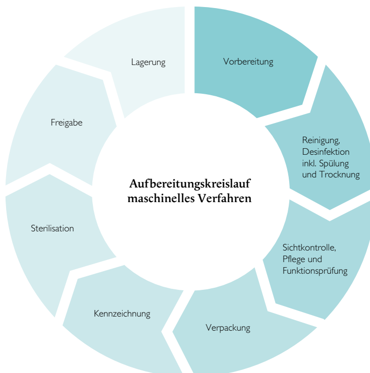
Abbildung 4: Aufbereitungskreislauf maschinelles Verfahren
