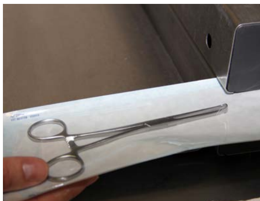
Die Folien-/Papierverpackung erhält eine Siegelnaht
