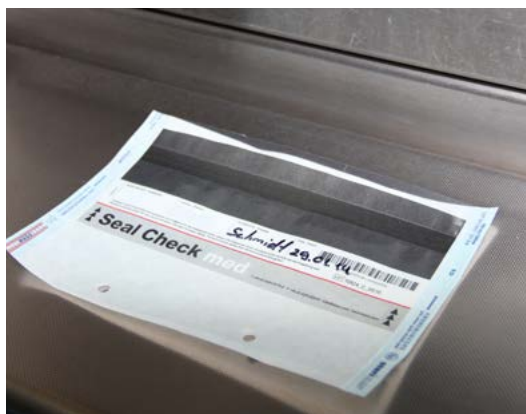
Seal-Check-Test: Beurteilung der Siegelnaht
