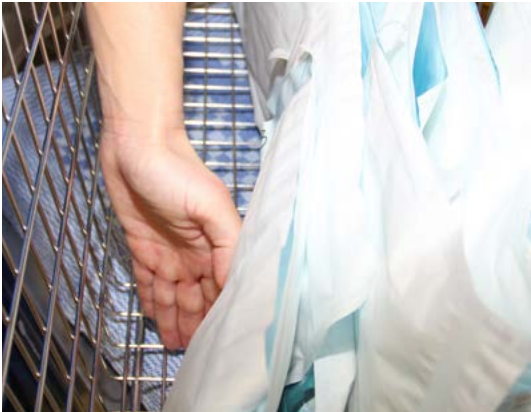
Korrekte Bestückung des Beladungskorbs
